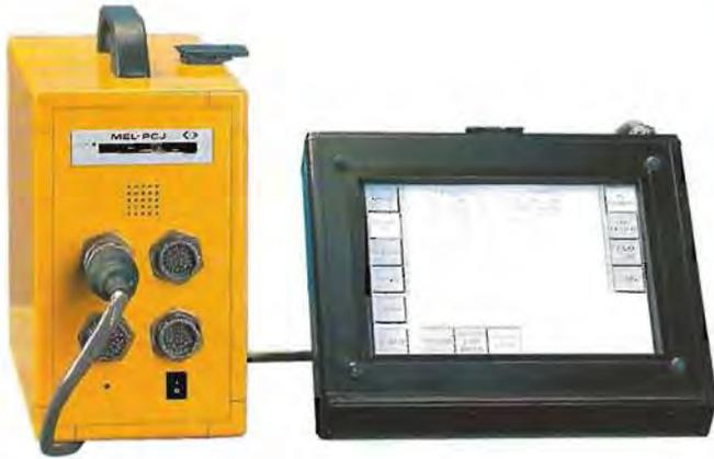
Das modulare Bedienkonzept der LMK 3000 macht flexibel. Vom konventionellen Dreimannflug bis zum GPS gestützten Einmannflug reichen die Möglichkeiten. Mit dem Zentralmodul CM 3000 steht erstmals ein Bedienrechner bereit, der die Hardware-Voraussetzungen bietet für die Integration eines Bildflug-Managementsystems sowie anderer, die Flugmission unterstützender Systeme.
